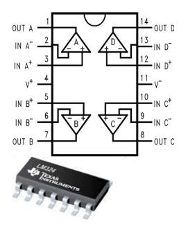
Fig: Quad OP-Amp IC Package
