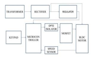
Fig .4 : Block Diagram
