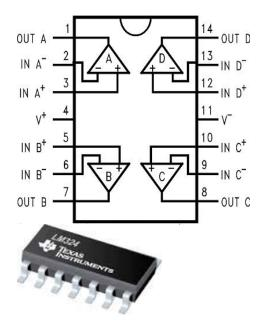
Fig: Quad OP-Amp IC Package
